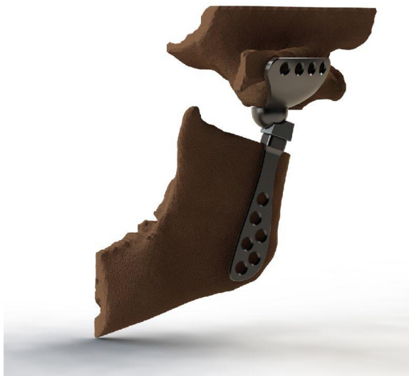
Obrázek 1 Model a funkční vzorek implantátu temporomandibulárního kloubu
