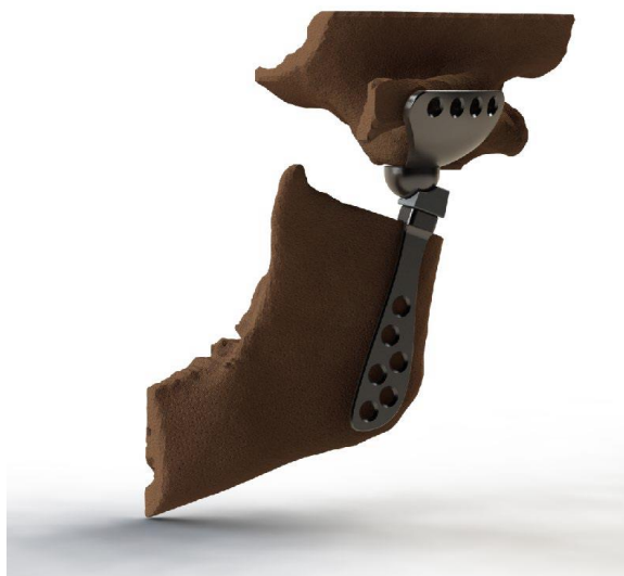
Obrázek 1 Model a funkční vzorek implantátu temporomandibulárního kloubu
