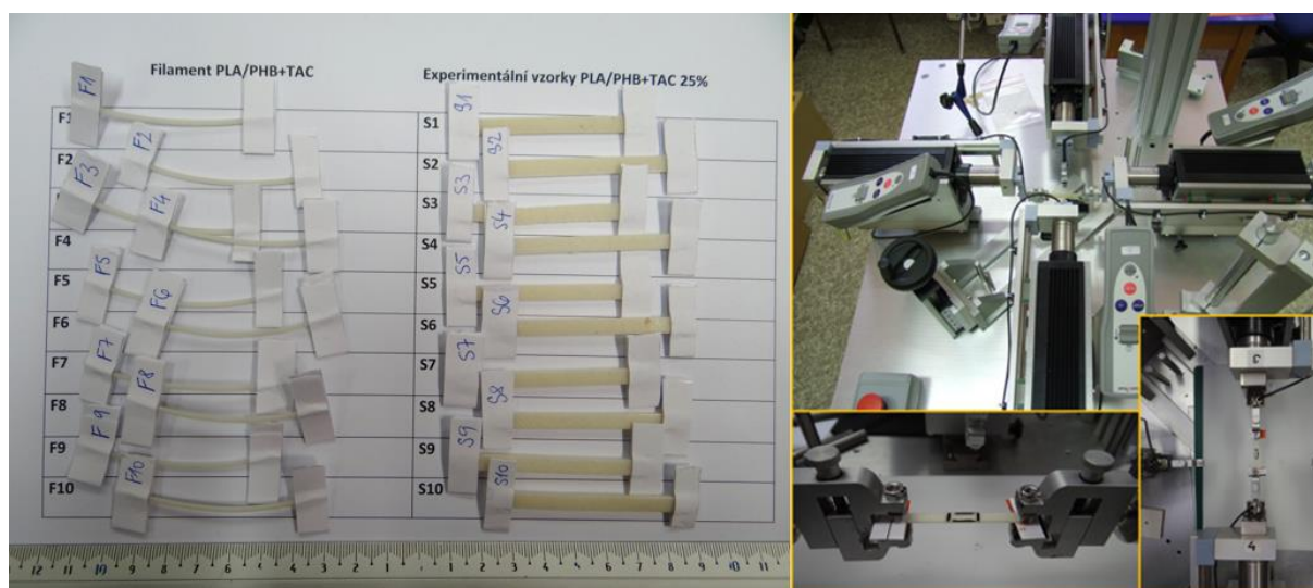
Obrázek 1 Vlevo – samotné filaments a 3D výtiskované vzorky z PLA-PHB připravené pro jednoosou tahovou zkoušku. Vpravo – testovací zařízení a v detailu vzorek upnutý do čelistí.
