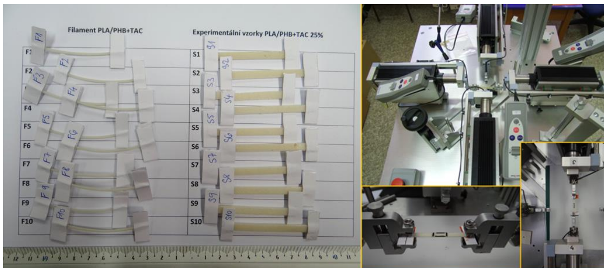
Obrázek 1 Vlevo – samotné filenty a 3D vtištěné vzorky z PLA-PHB připravené pro jednoosou tahovou zkoušku. Vpravo – testovací zařízení a v detailu vzorek upnutý do čelistí.
